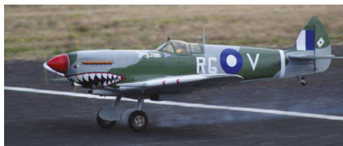
Troisième en National, le très beau Spitfire MK VIII d'Olivier Delbouys est issu d'un kit Hangar 9. L'avion a été réentoilé et modifié. Le train rentrant provient de la gamme E-flite et le moteur est un Saito 180 méthanol.
