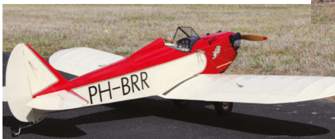
Gilbert Geay a construit ce superbe Fly Baby d'après la liasse de plan du réel. Cela donne une maquette bluffante de réalisme, d'autant que la finesse de réalisation est absolument remarquable. La motorisation est confiée à un O.S Gemini 160 (26 cc bicylindre). L'envergure est de 2,18 m pour une masse de 6 kg.
