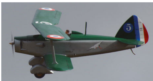
Sébastien Giraud a construit ce très original Spad 510 d'après le plan RCM. Le biplan est particulièrement léger pour son 1,80 m d'envergure puisqu'il affiche une masse de 5,2 kg. La motorisation électrique est alimentée par un LiPo 6S.
