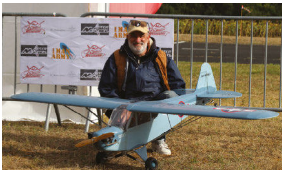
Eric Gainard présentait ce superbe Piper aux couleurs de la Navy. Cette maquette provient de la gamme VQ Models et a été améliorée. Elle fait 2,3 m d'envergure. La motorisation électrique est assurée par un E-Flite 110 qui emmène avec aisance les 7 kg de l'avion.
