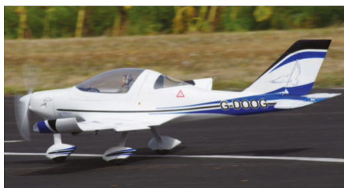
Ce magnifique Sting 2000 S4 est piloté par Thierry Mignot. Ce modèle provient de la gamme Cy Model. L'avion a une envergure de 2,20 m pour une masse de 6,7 kg. La motorisation est électrique et alimentée en LiPo 10S.
