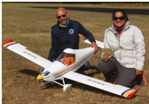
L'avion champion de France en National est le très original Caudron MC 30 présenté par Arnaud Proux. Ce modèle est personnel, il mesure 2,20 m d'envergure et est motorisé par un O.S 70.
