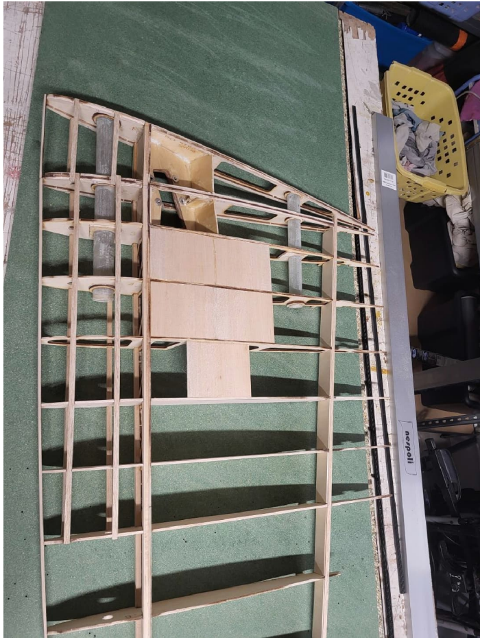
Renfort balsa dans la zone du puit de roue
