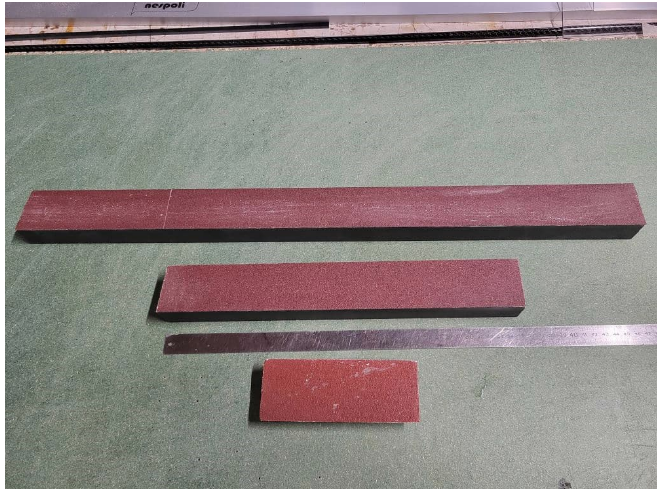
Cales à poncer prêtes pour l'opération ponçage de l'aile qui doit être vraiment soigné avec les coffrages en fibre de verre épaisseur 0,3mm
