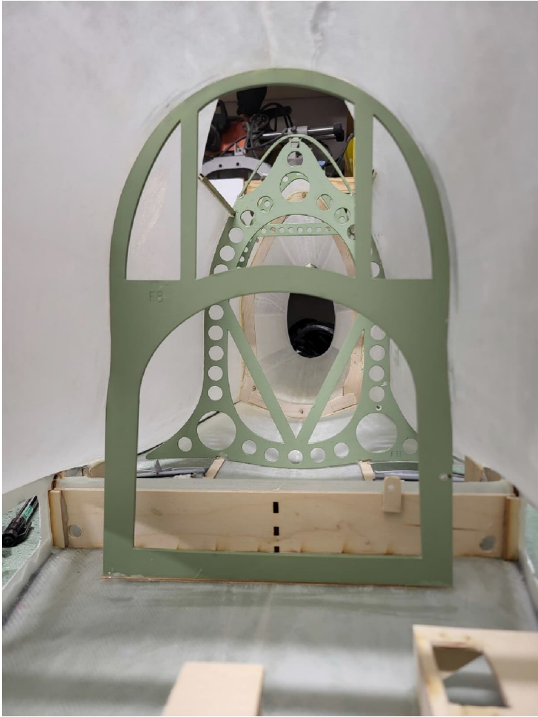
Les couples visibles à travers le cockpit ont été peints avant collage: 2 couches de bouche pore + 1 couche de primaire + 2 couches de peinture à maquette Tamiya.
