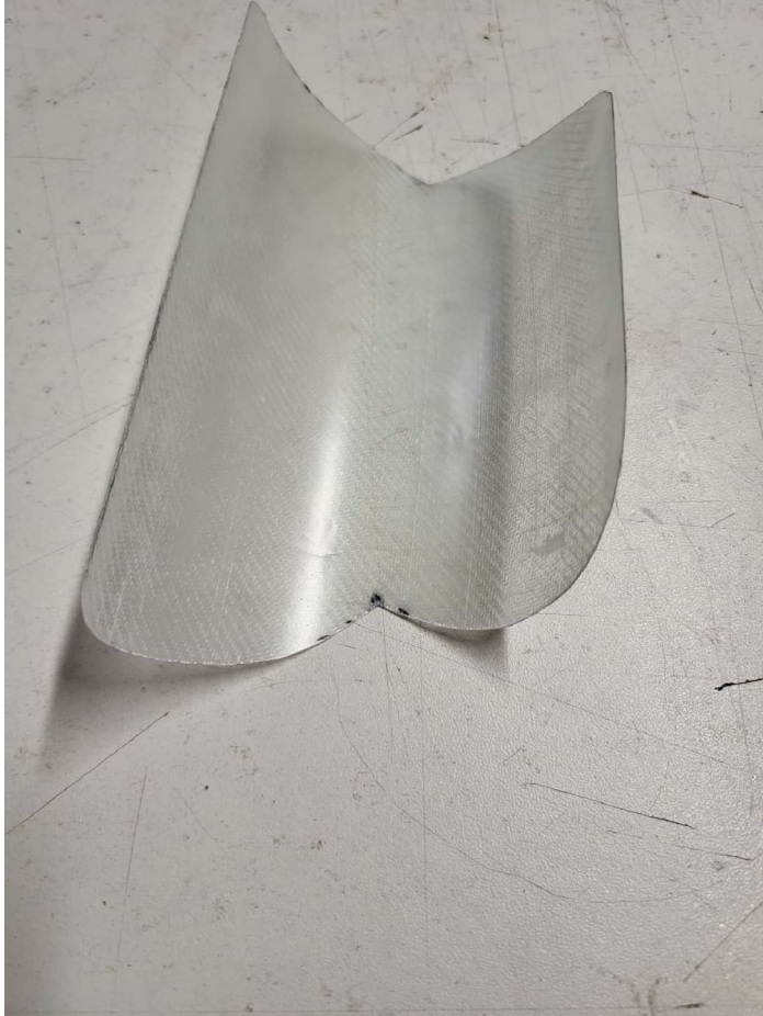
L'arrête supérieure de ce déflecteur en \frac{1}{2} rond est renforcée avec un plat carbone de 3x1mm
