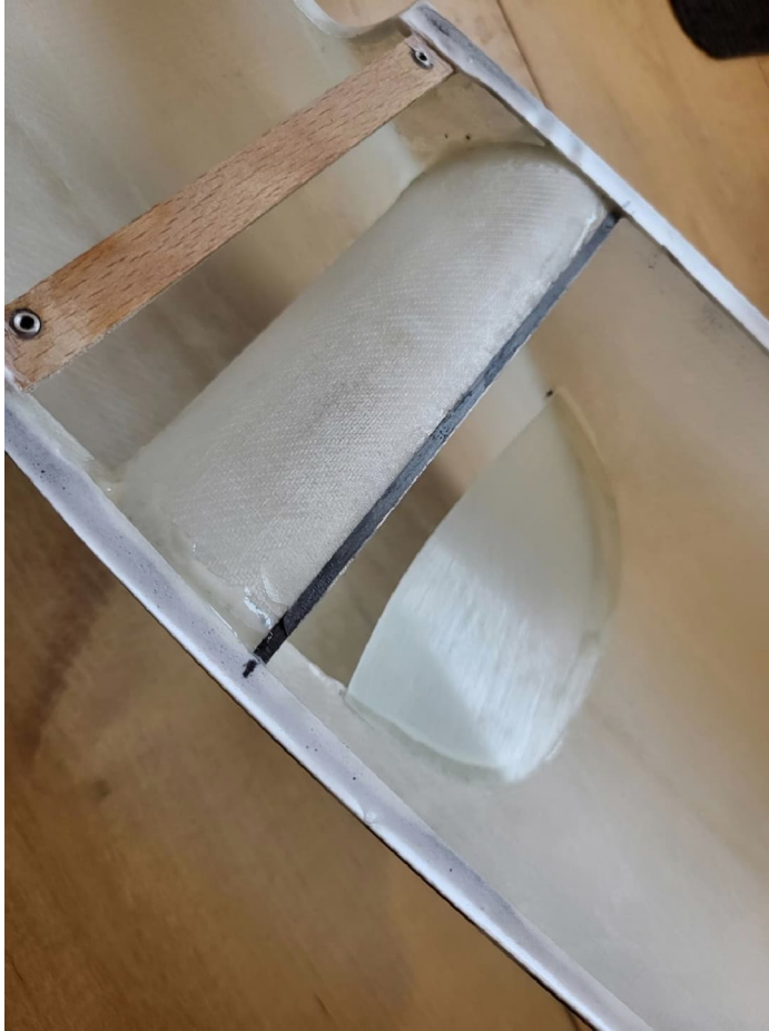
L'arrête supérieure de ce déflecteur en \frac{1}{2} rond est renforcée avec un plat carbone de 3x1mm
