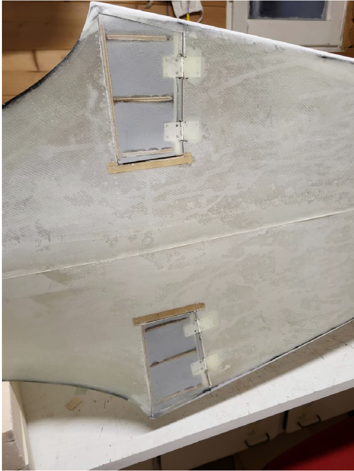
Les volets ont reçu une couche de primaire sur la face interne avant de coller les charnières au fuselage.
