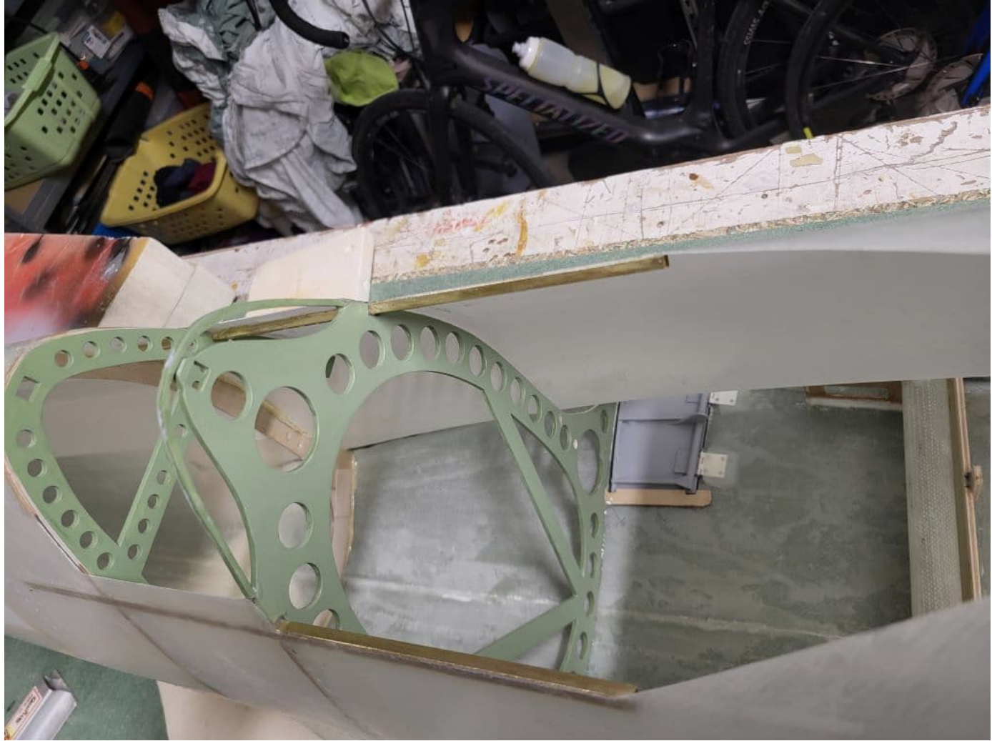
Les couples visibles à travers le cockpit ont été peints avant collage: 2 couches de bouche pore + 1 couche de primaire + 2 couches de peinture à maquette Tamiya.
