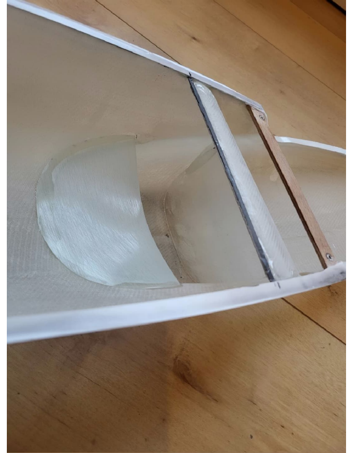
L'arrête supérieure de ce déflecteur en \frac{1}{2} rond est renforcée avec un plat carbone de 3x1mm
