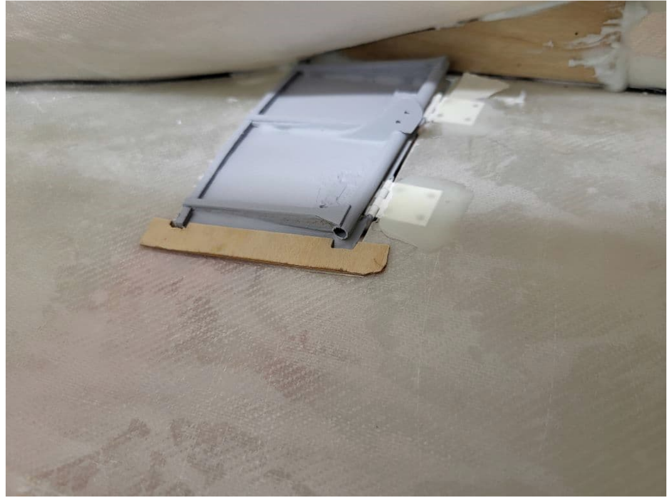
Les volets ont reçu une couche de primaire sur la face interne avant de coller les charnières au fuselage.
