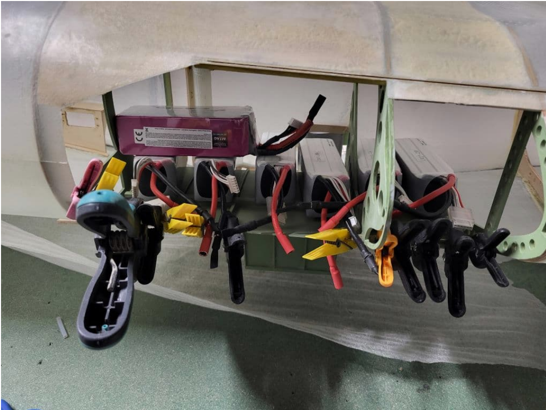
Collages à la colle PU des panneaux internes après peinture.
