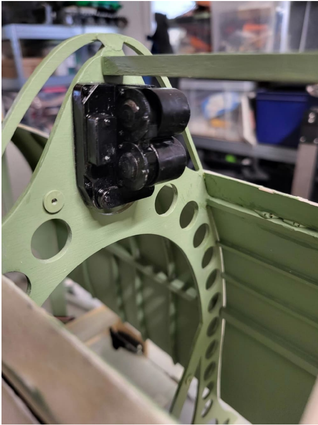
Régulateur de tension fait en impression 3D et installé derrière le siège du pilote.
