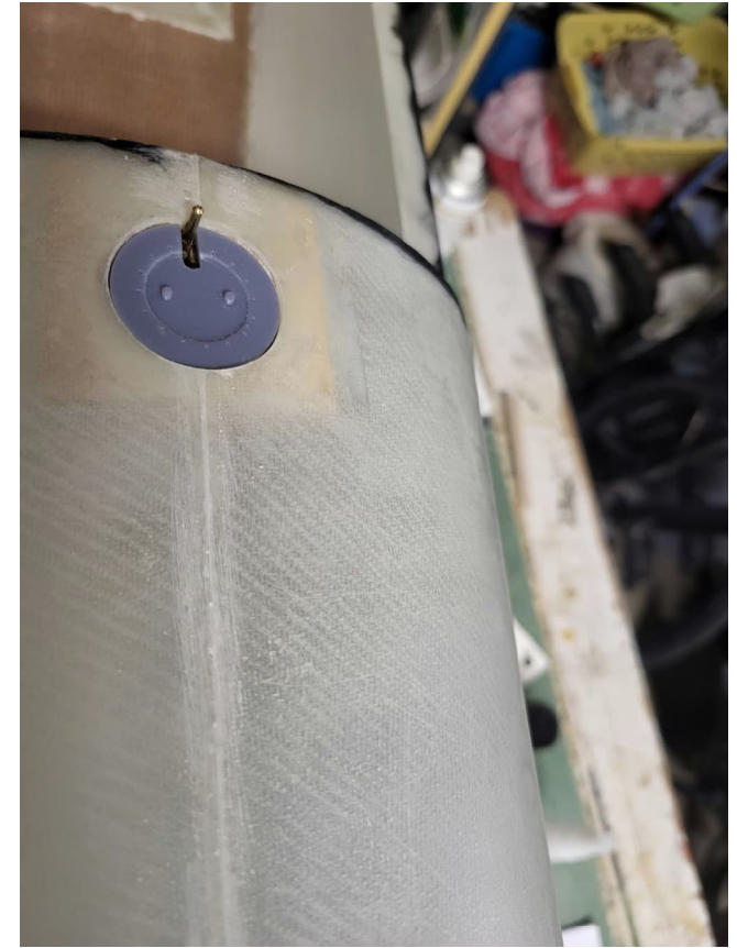
Bouchon de réservoir fait en impression 3D également
