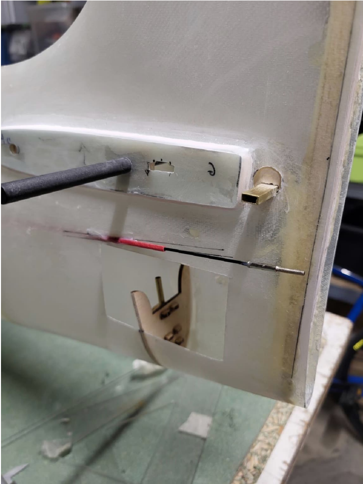
Détails sur les commandes des empennages et des petits volets d'atterrissage situés sous le fuselage.
