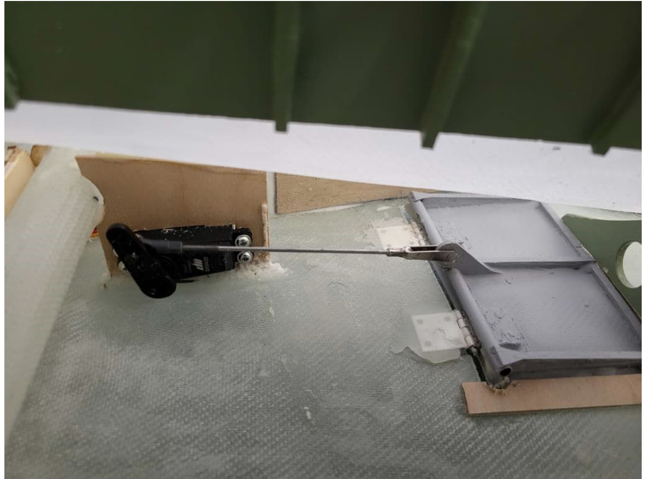
Détails sur les commandes des empennages et des petits volets d'atterrissage situés sous le fuselage.
