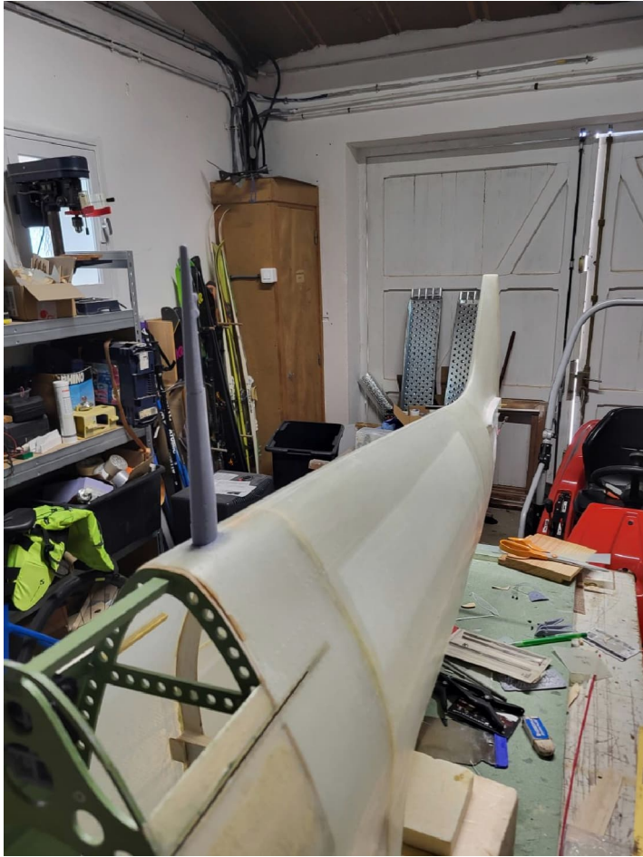
Mat d'antenne réalisé en impression 3D
