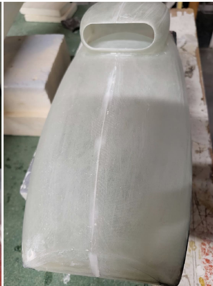
Après ponçage (à l'eau)
