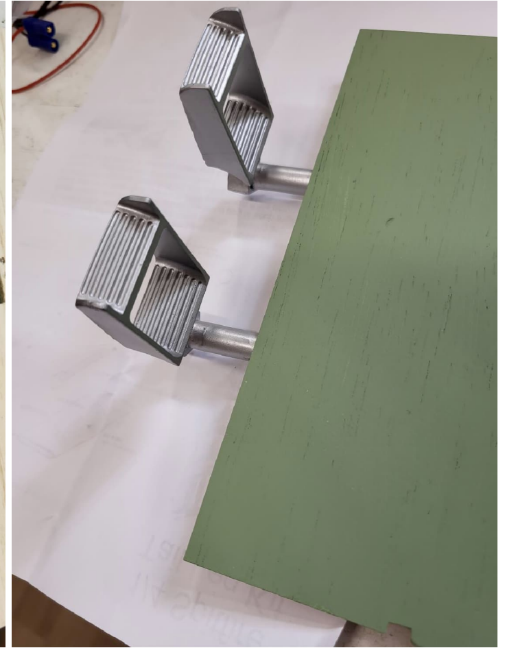
Fixation des pédales sous le plancher de la cabine
