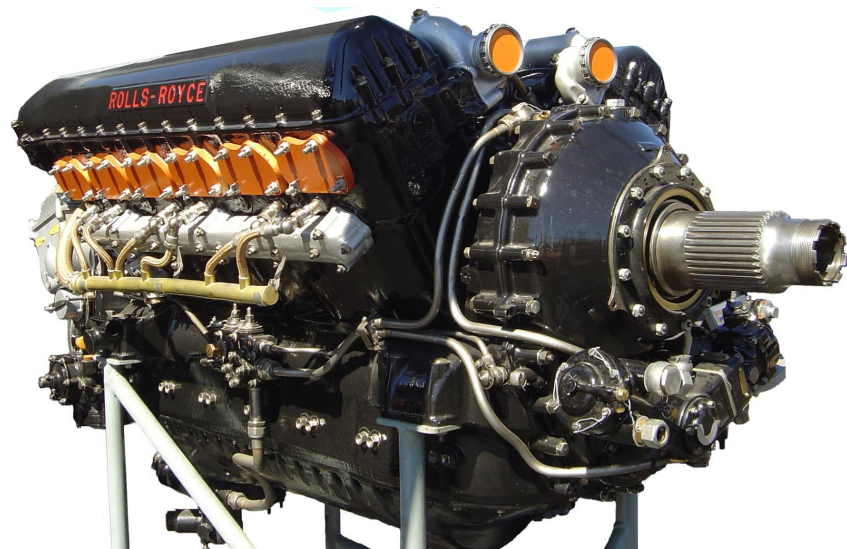
V12 merlin 27 litres de cylindrée 2000 chevaux
