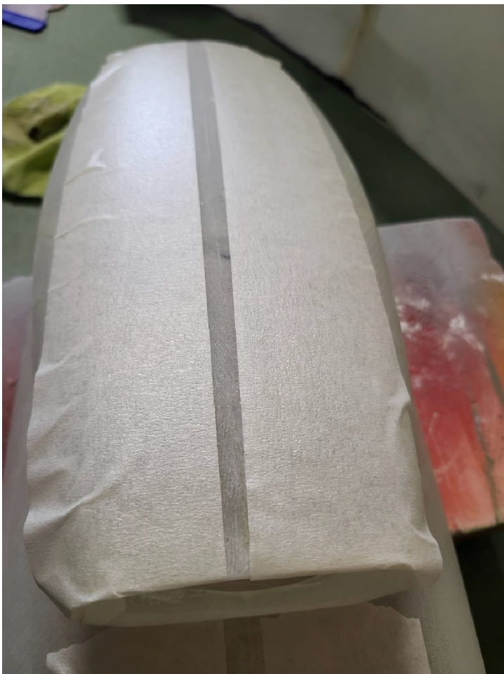
Ruban de masquage avant application du mastic carrossier au plan de joint
