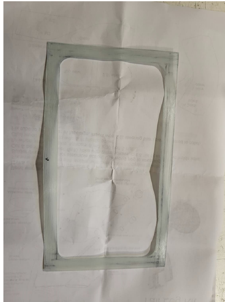
Cadre pour le cockpit arrière découpée dans une plaque de fibre de verre épaisseur 0,3 mm
