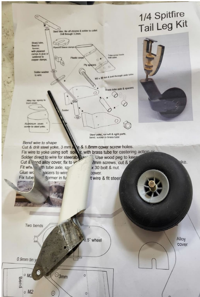
Construction de la roulette de queue
