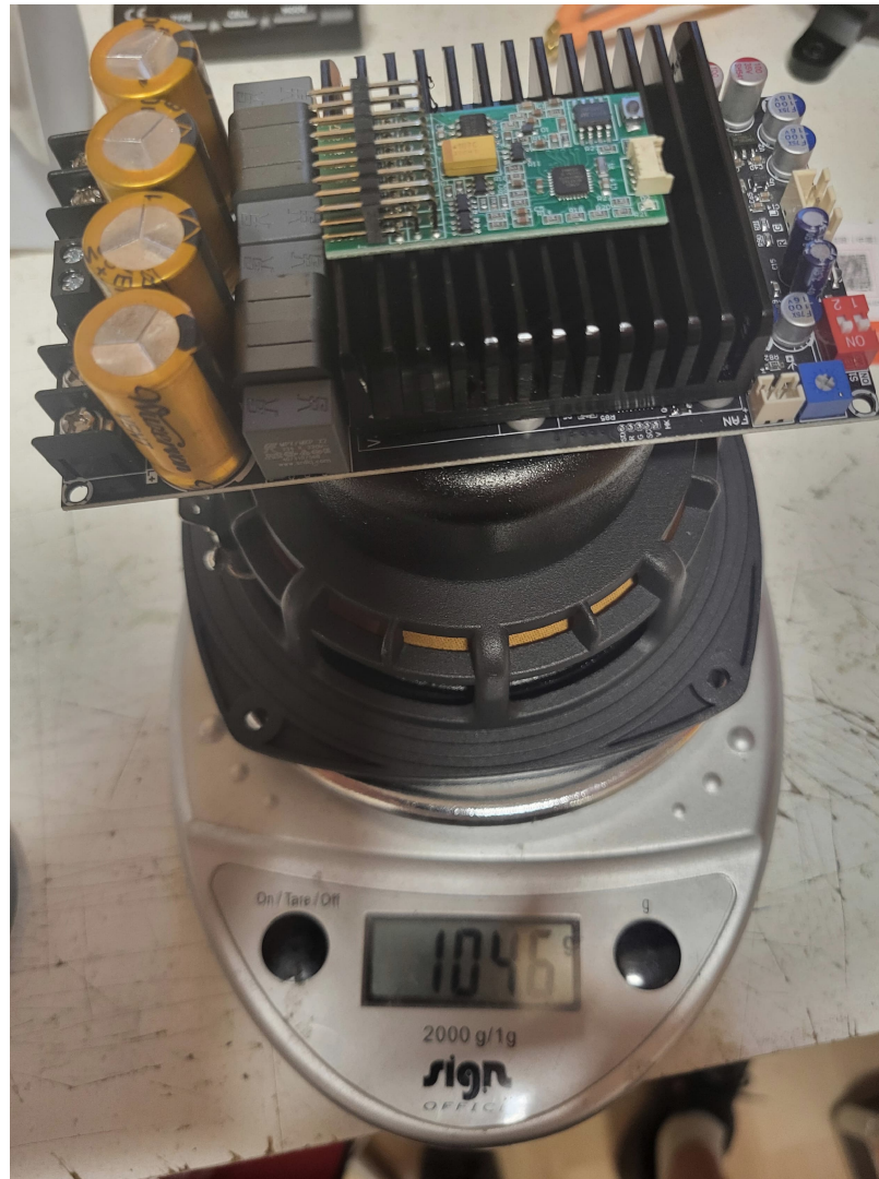
L'ensemble haut parleur + amplificateur + carte son (DasMikro TBS Mini Sound Unit V3) pèse 1046 grammes sans le câblage.
