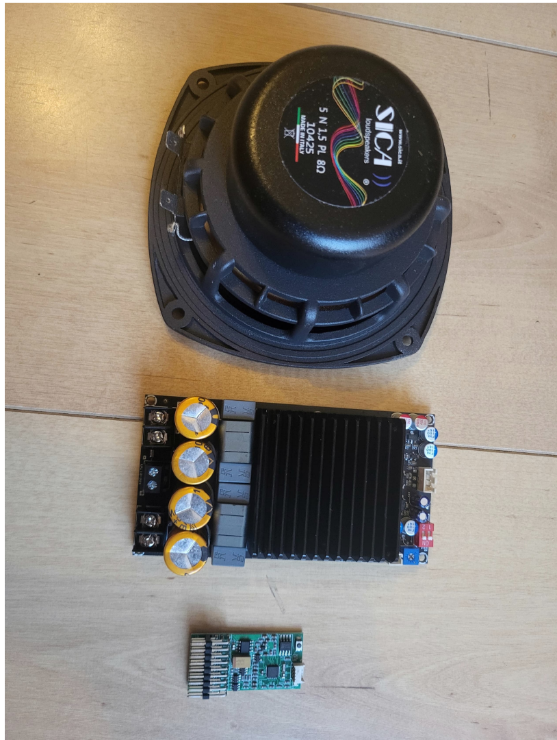
L'ensemble haut parleur + amplificateur + carte son (DasMikro TBS Mini Sound Unit V3) pèse 1046 grammes sans le câblage.
