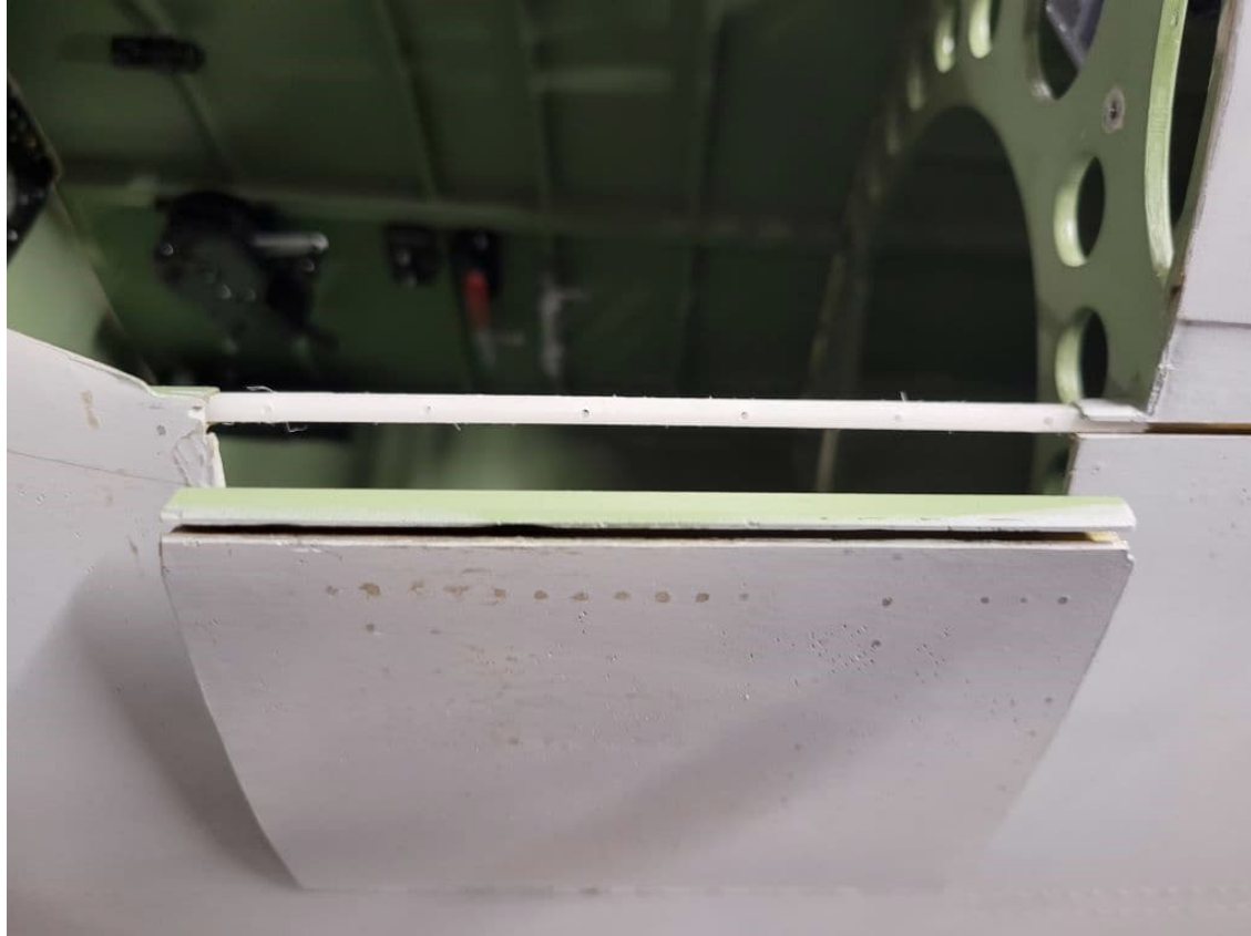
La pièce en Delrin est plus longue que la porte latérale pour permettre le verrouillage de celle-ci
