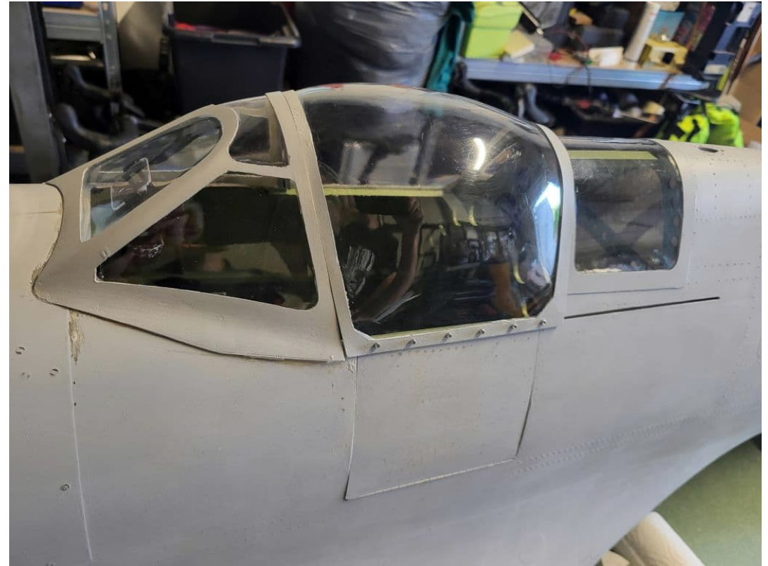
La glissière fonctionne correctement avec une ouverture/fermeture à la main (pas de servos)
