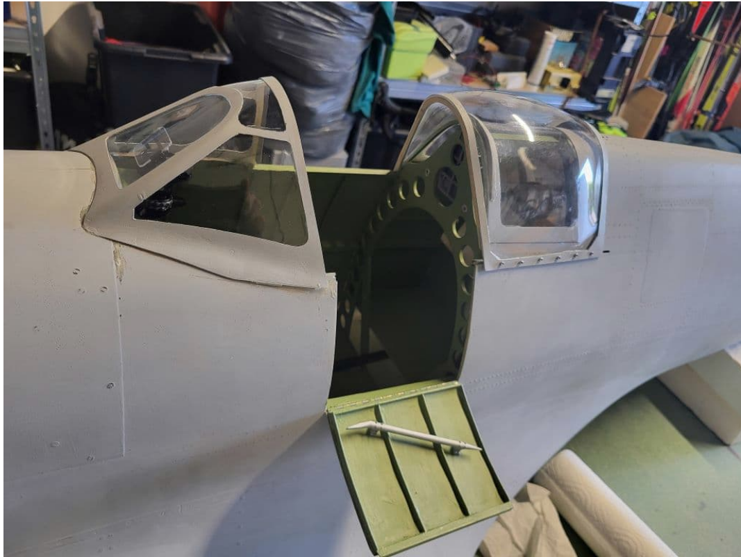
La glissière fonctionne correctement avec une ouverture/fermeture à la main (pas de servos)
