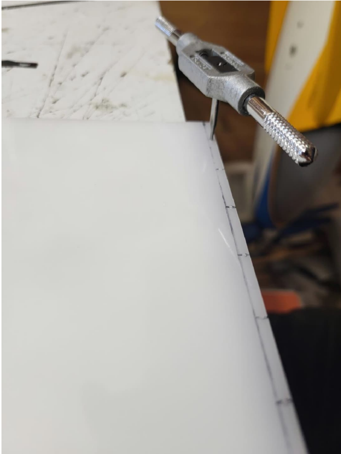
Percage diamètre 1 mm et taroudage M1.4
